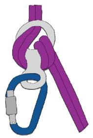
Beim Sichern mittels Abseilachter sollte das Sicherungsseil immer wie gezeigt von unten in den Achter eingeführt werden. So ist die Bremswirkung höher.
